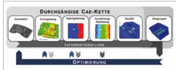
Abbildung 3: virtuelle Prozesskette (CAE-Kette) zur Simulation des Bauteilverhaltens
