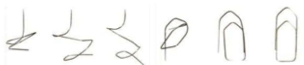
Büroklammer aus Nitinol. Sie kann verbogen werden und springt bei Erwärmung wieder in ihre „Büroklammer-Form“ zurück. (Quelle: www.memory-metalle.com)
