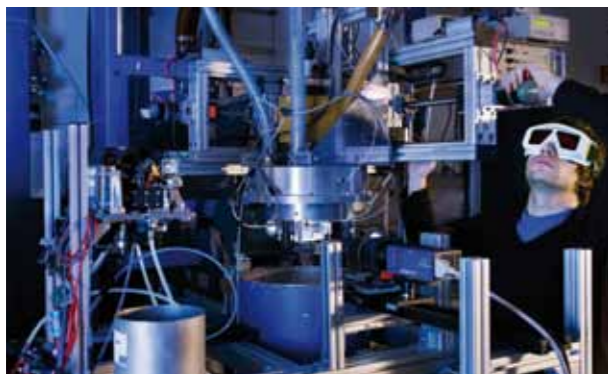
Testapparatur zur Untersuchung von Flüssigkraftstoffzerstäubern am ITS
