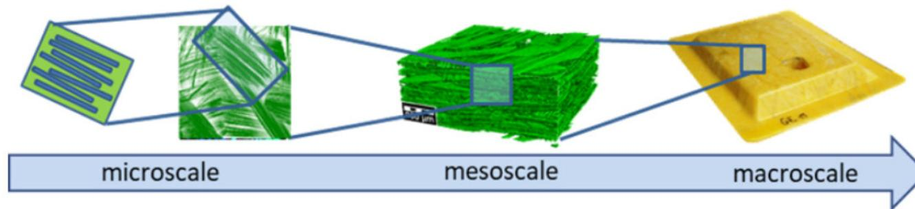
Multiskalenmodellierung in der Kontinuumsmechanik (siehe Görthofer et al. : [Virtual Process Chain of Sheet Molding Compound: Development, Validation and Perspectives](#). Composites Part B 169, 133-147, 2019)
