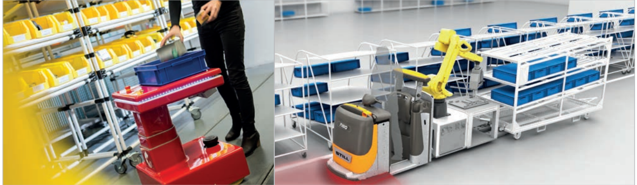
Abb. links: Das Assistenzsystem FiFi erleichtert den manuellen Transport in der Intralogistik; Abb. rechts: QBIK versorgt autonom Regale mit Kisten
