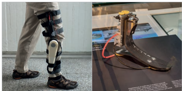
Abb.: BEH-System für eine aktive Knie-Orthese basierend auf einem Generator mit Elektroaktivem Polymer (EAP). Beim Laufen wird das EAP gestreckt, dann schlagartig wieder entspannt; Foto: Pylatiuk/KIT
